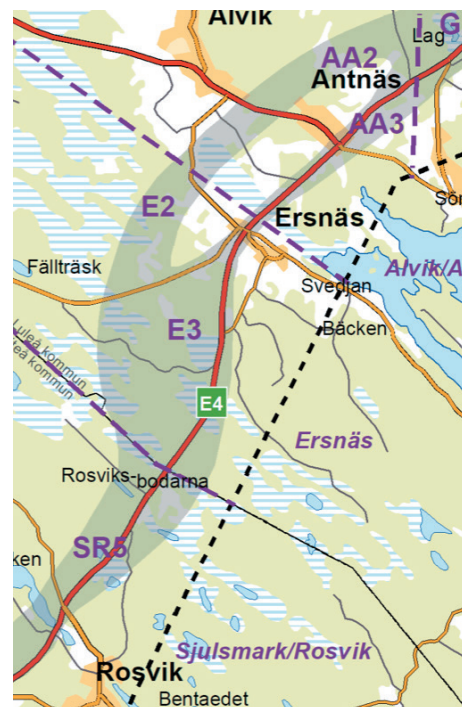
Det grå fältet visar planerad dragning av Norrbotniabanan förbi Ersnäs, två alternativ finns, AA2 och AA3.
